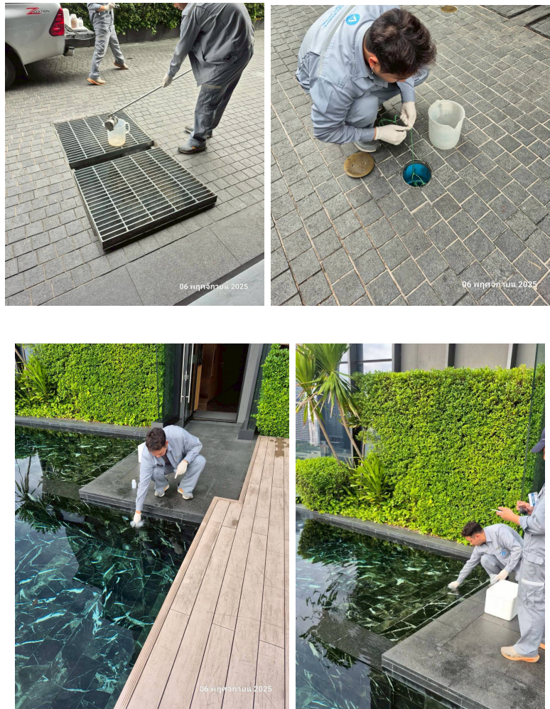
ภาพที่ 4 การเก็บตัวอย่างน้ำทิ้งและน้ำสระว่ายน้ำ
